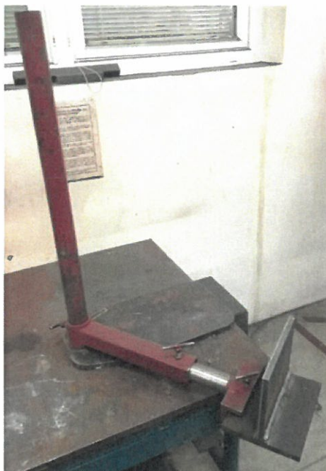
Obrázek 1 Ukázka stojanu s upevněným zkoušeným materiálem
