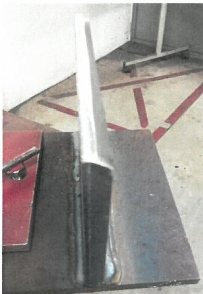
Obrázek 2 Ukázka zkoušky – broušení první hrany materiálu Broušení na protější hranu materiálu. Viz obrázek 3.
