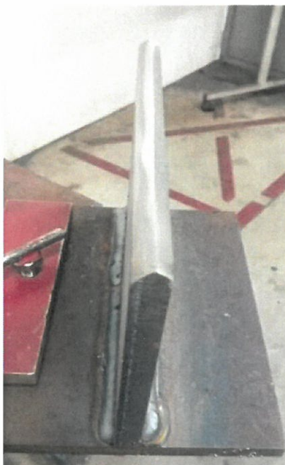
Obrázek 3 Ukázka zkoušky – broušení druhé hrany materiálu
