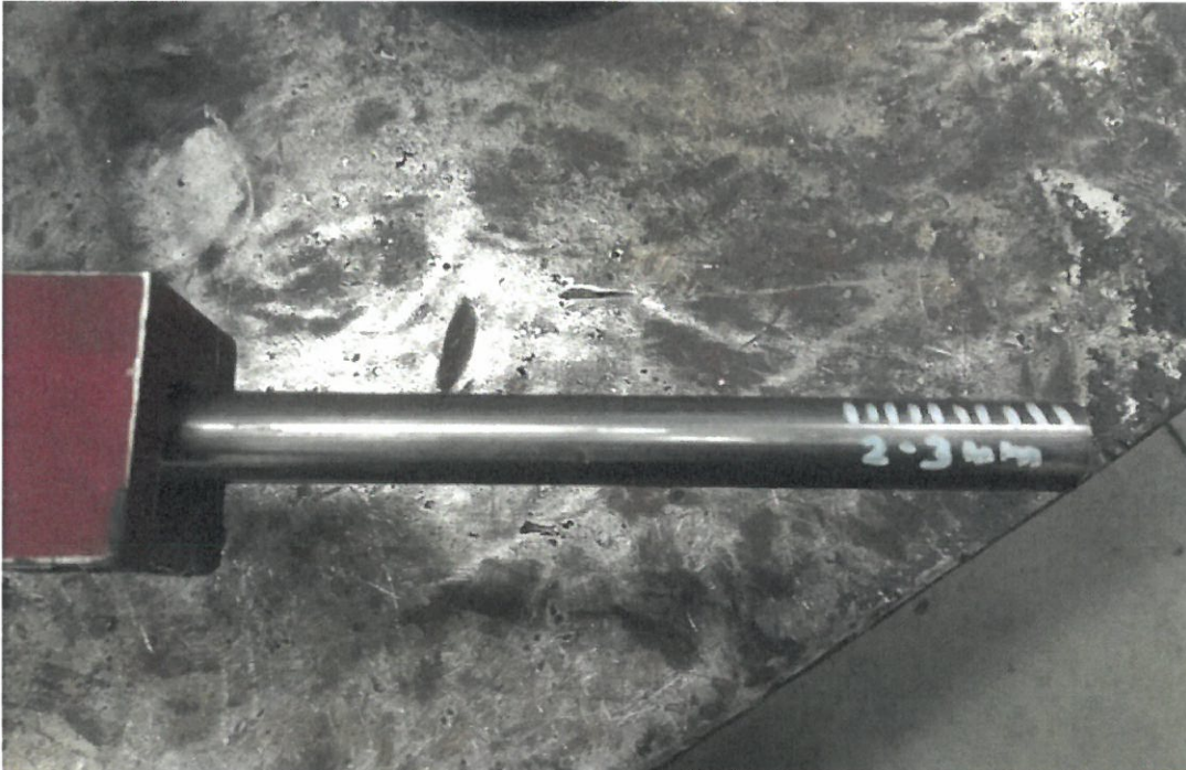
Obrázek 2 Ukázka zkoušky – naznačení řezání prstenců
