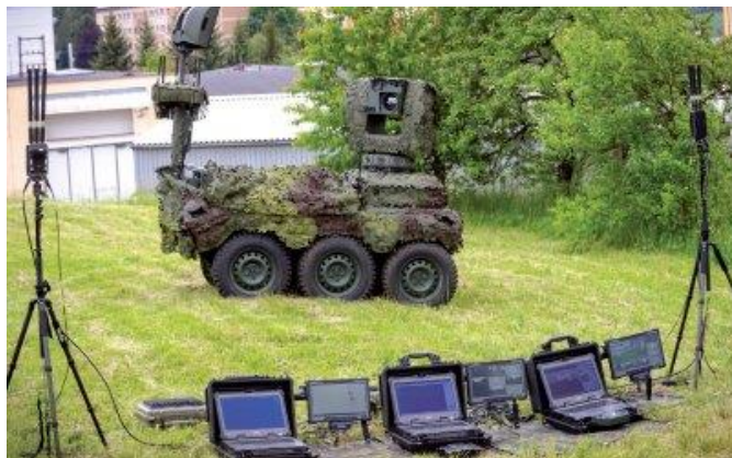
UGV - PZ d x š x v – 2913 x 1665 x 2348 mm hmotnost – 1,5 t
